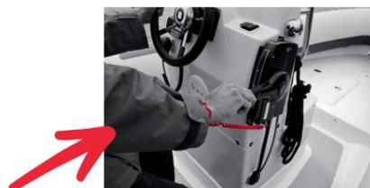
**NOT-AUS-SCHALTER** Die Notfalleinrichtung ermöglicht das sofortige Abstellen des Motors im Gefahrenfall (z. B. versehentlicher Sturz ins Wasser). Während der Schifffahrt muss der Lenker sie wie in der Abbildung gezeigt am Handgelenk befestigt halten.
