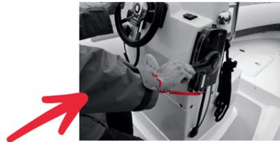
**STACCO DI SICUREZZA:** il dispositivo di emergenza consente di arrestare immediatamente il motore in caso di pericolo (es. caduta accidentale in acqua). Durante la navigazione il conduttore deve tenerlo allacciato al polso come mostrato in figura.
